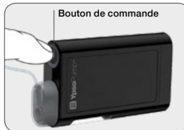
**3/7:** Réglez la quantité de bolus requise en exerçant une courte pression sur le bouton de commande pour chaque incrément de bolus. La pompe à insuline confirme chaque pression sur le bouton par le biais d'une courte vibration. À chaque pression exercée sur le bouton de commande, la quantité de bolus augmente en fonction de l'incrément de bolus qui a été défini. La quantité de bolus maximale est de 30,0 U.
