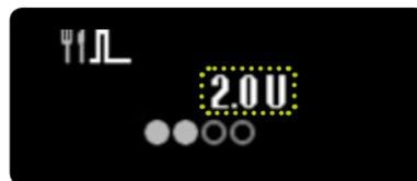
**5/7:** Ensuite, la pompe mylife™ YpsoPump® confirme chaque incrément de bolus par le biais d'un bref signal de vibration.
