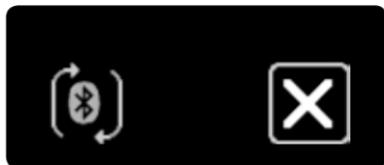
**3/6:** La pompe mylife™ YpsoPump® est prête pour le couplage Bluetooth® et attend la demande de couplage du dispositif compatible Bluetooth®.
