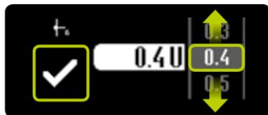
**3/4:** L'écran permettant de régler le volume d'amorçage apparaît. Pour l'amorçage, sélectionnez le volume approprié pour votre canule, entre 0,1 U et 1,0 U, selon les instructions du mode d'emploi de votre dispositif de perfusion mylife™ YpsoPump® Orbit®. Confirmez en touchant . La pompe mylife™ YpsoPump® vibre brièvement et la canule est amorcée avec la quantité d'insuline définie.
