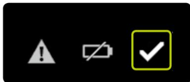
L'alarme "Pile inadaptée" apparaît si vous insérez une pile dont la tension est trop élevée. Confirmez en touchant
