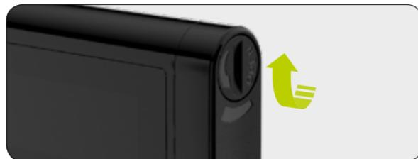
**2/11:** Fermez le compartiment de la pile en appliquant une pièce de monnaie dans la fente de son couvercle et en effectuant une rotation dans le sens des aiguilles d'une montre jusqu'à la fermeture complète.
