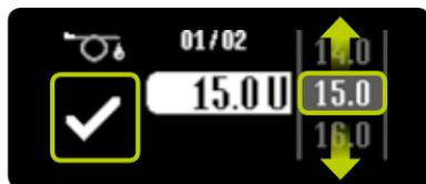
**3/6:** L'écran permettant de régler le volume d'amorçage apparaît. Pour le volume d'amorçage, sélectionnez une valeur appropriée pour votre dispositif de perfusion, c'est-à-dire entre 1,0 U et 30,0 U. Confirmez en touchant .
