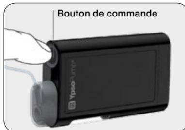
**1/7:** Exercez une pression longue sur le bouton de commande jusqu'à ce que la pompe mylife™ YpsoPump® émette une longue vibration.
