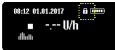
**2/6:** La pompe mylife™ YpsoPump® est dotée d'un verrouillage d'écran. Il est visualisé par une icône représentant un verrou en haut à droite de l'écran, à côté de l'indicateur de charge de la pile.
