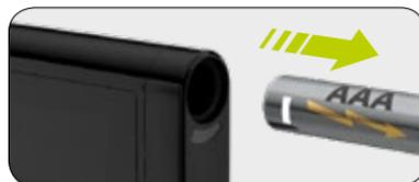
**2/2:** Ouvrez le couvercle du compartiment de la pile et retirez la pile. Refermez le couvercle du compartiment de la pile et rangez la pompe mylife™ YpsoPump® en lieu sûr.
