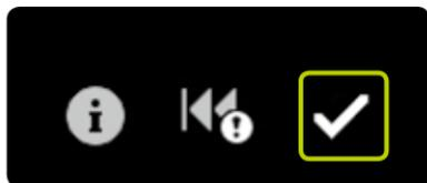
L'avertissement "Retour incomplet du piston" apparaît si la fonction de retour du piston n'a pas encore pu être réalisée correctement. L'avertissement peut être déclenché en raison de la présence de saleté (sable, insuline séchée, etc.) dans le compartiment de la cartouche ou, généralement, lorsque le mécanisme d'entraînement présente un dysfonctionnement. Ce défaut peut également être déclenché en touchant le piston avec un objet pendant sa phase de retour.
