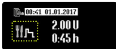
**4/4:** Exemple de bolus mixte: le pourcentage de la fraction immédiate est affiché en alternance avec la durée de la fraction prolongée, à des intervalles de 2 secondes.
