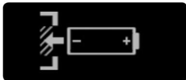
**3/5:** L'écran d'orientation de la pile indique comment insérer la pile AAA. Il apparaît sur l'écran d'état. Si la pompe à insuline est en mode administration et que la pile n'est pas insérée en l'espace de 5 minutes, une alarme se déclenche.
