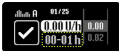
**3/8:** L'écran permettant de régler le débit basal pour la première heure apparaît, et commence à minuit (00-01 h). Lors de la première mise en service de la pompe (première programmation d'un profil de débit basal), si vous confirmez une valeur horaire, le réglage s'applique pour l'heure suivante comme valeur de départ.
