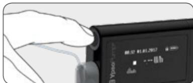
**1/6:** L'écran d'état de la pompe mylife™ YpsoPump® est mis sous tension et hors tension en appuyant sur le bouton de commande (pression brève).
