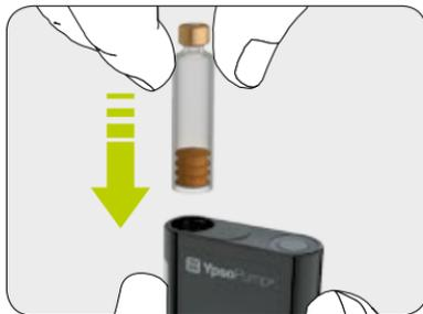
**1/2:** Tenez la pompe mylife™ YpsoPump® verticalement, l'ouverture du compartiment de la cartouche dirigée vers le haut. Insérez un réservoir à remplir de 1,6 ml ou une cartouche préremplie de 1,6 ml.
