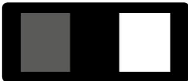
**5/11:** Trois schémas de test apparaissent successivement à l'écran. Les 3 x 3 rectangles de test doivent s'afficher en intégralité et présenter une luminosité uniforme.
