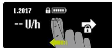
**3/6:** Faites un glissement vers la gauche pour déverrouiller l'écran d'état et le menu principal. Trois icônes apparaissent numérotées 1, 2 et 3 (déverrouillage de l'écran).
