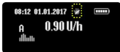
**4/5:** L'écran d'état apparaît. La fonction de verrouillage d'accès activée est symbolisée par la présence d'une icône de verrouillage d'accès en haut de l'écran.
