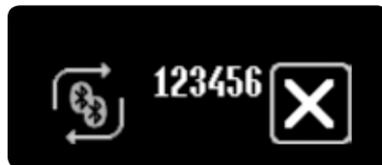
**4/6:** Un code à six chiffres apparaît à l'écran de la pompe mylife™ YpsoPump® et les flèches se mettent en rotation. Saisissez ce code sur votre dispositif compatible Bluetooth®.
