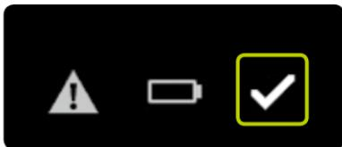
L'alarme "Pile déchargée" apparaît lorsque la pile ne contient plus assez d'énergie et doit être changée. Confirmez en touchant  et insérez une nouvelle pile alcaline AAA (LR03). Suivez la procédure décrite à la page 136.
